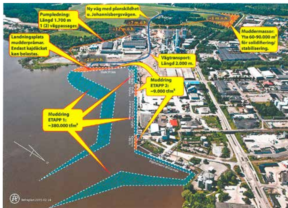
Muddretapper och solidifiering/stabilisering i Västerås hamn.
