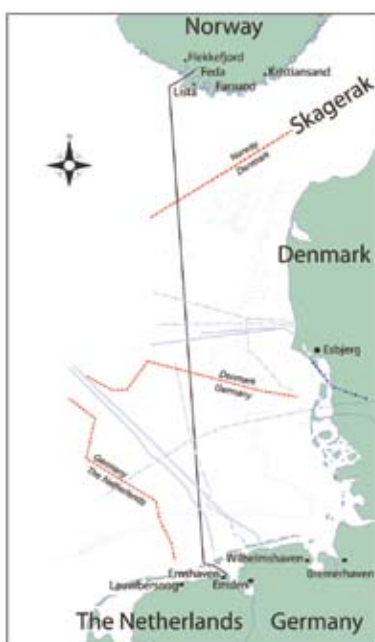
NorNed-länken blir med sina 580 km världens längsta undervattenskabel för högspänd likström.
